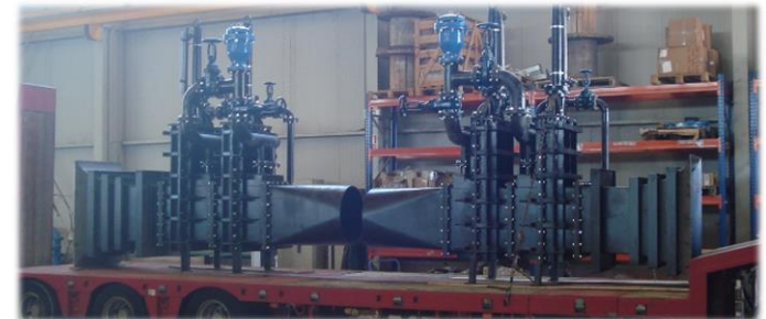
Compuertas Bureau y conducciones instaladas en la balsa de La Restinga (Guadajoz, Sevilla)
