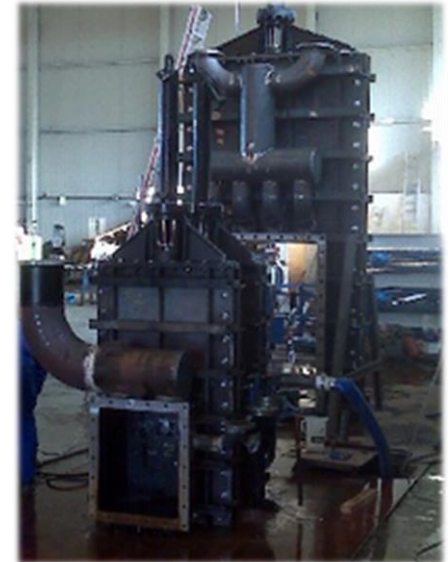
Compuertas Bureau de la balsa de El Rosario en los Rosales (la pequeña) y de la balsa de La Gitana en Lora del Río (la grande).
