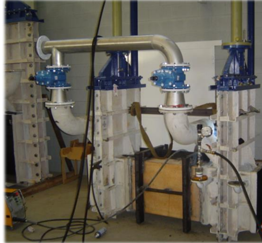
Compuertas Bureau del azud de Garganta Fría (pruebas en taller).
