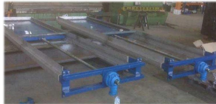
Compuertas en el proceso de fabricación en las instalaciones de INAGEN destinadas a los canales de desbaste de la estación depuradora de aguas residuales (EDAR) de Casaquemada (Madrid).
