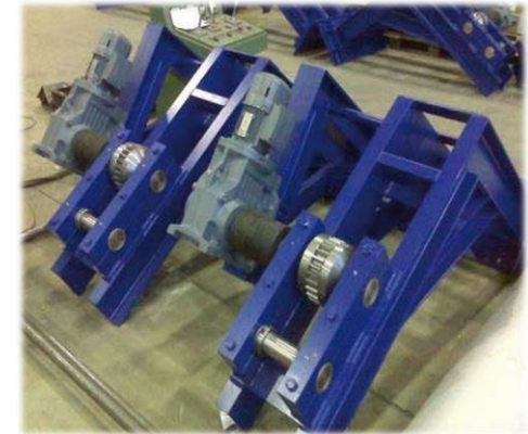
Accionamientos de los limpiarrejas lineales de entrada de agua a la balsa de La Restinga. Confederaci3n Hidrogr'afica del Guadalquivir
