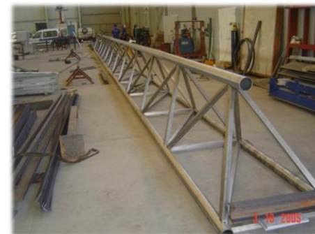
Toma flotante Castilblanco de los Arroyos Proceso de fabricación Embalse de Cala (Sevilla)
